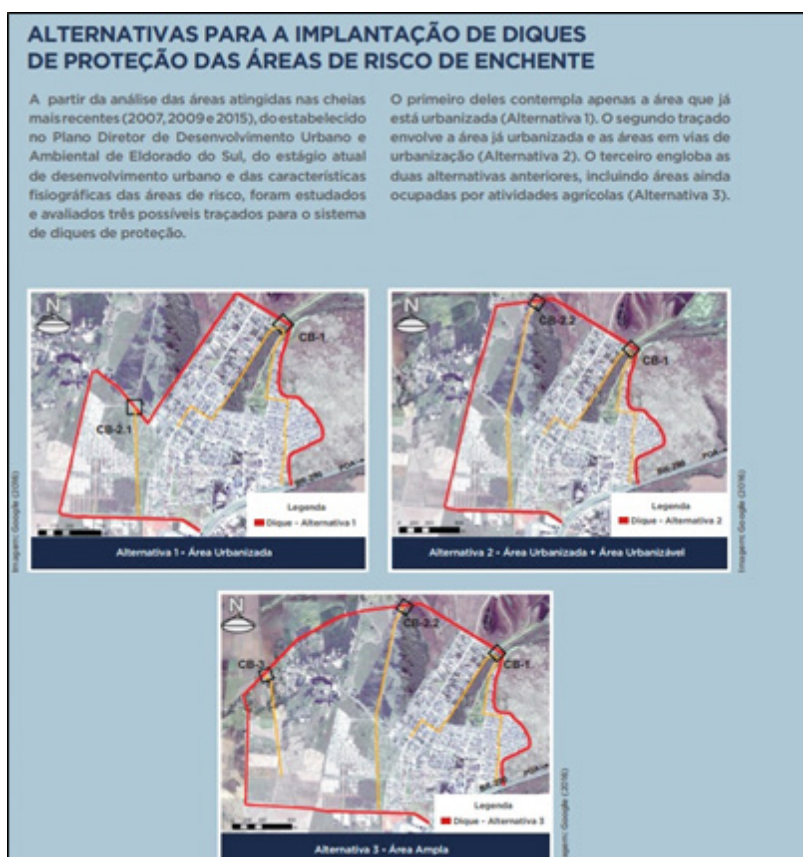
Figura 14 - Alternativas de sistemas estruturais de proteção contra cheias avaliados para Eldorado do Sul em estudo da Metroplan.
